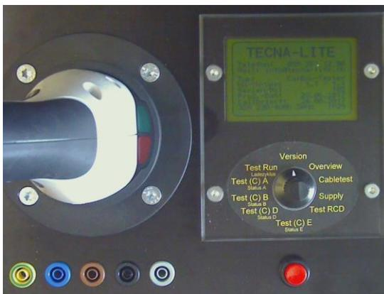
**La station de chargement se trouve en état C dès que le testeur CarBox y est connecté (C = chargement du véhicule).**
